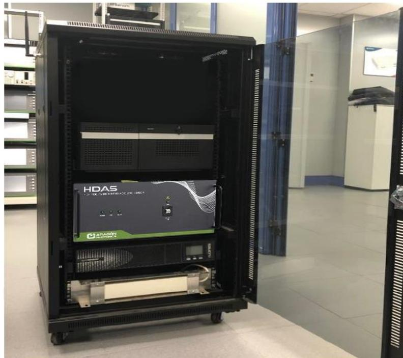
Figura 15. Sensor acústico distribuido (HDAS)
