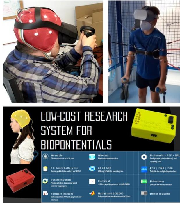
Figura 14. Aplicaciones realizadas en el BCILab. (Arriba) Aplicaciones de RV: video juego con interfaz de neurometría (arriba izquierda) y aplicación destinada a la discapacidad (arriba derecha). (Abajo) RABio w8, un equipo de electrofisiología desarrollado íntegramente en el laboratorio.
