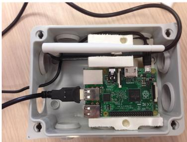
Interior del dispositivo, donde se muestra el mini-ordenador Raspberry Pi que ejecuta el software. (FOTO: UGRDIVULGA)
