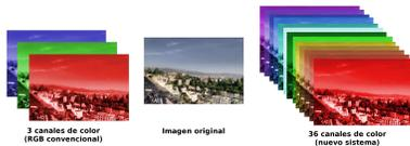
FOTO 1: Información espectral de una misma imagen, vista a través de un sistema convencional de tres canales de color (izquierda) y a desarrollado en la UGR (36 canales de color, a la derecha).
