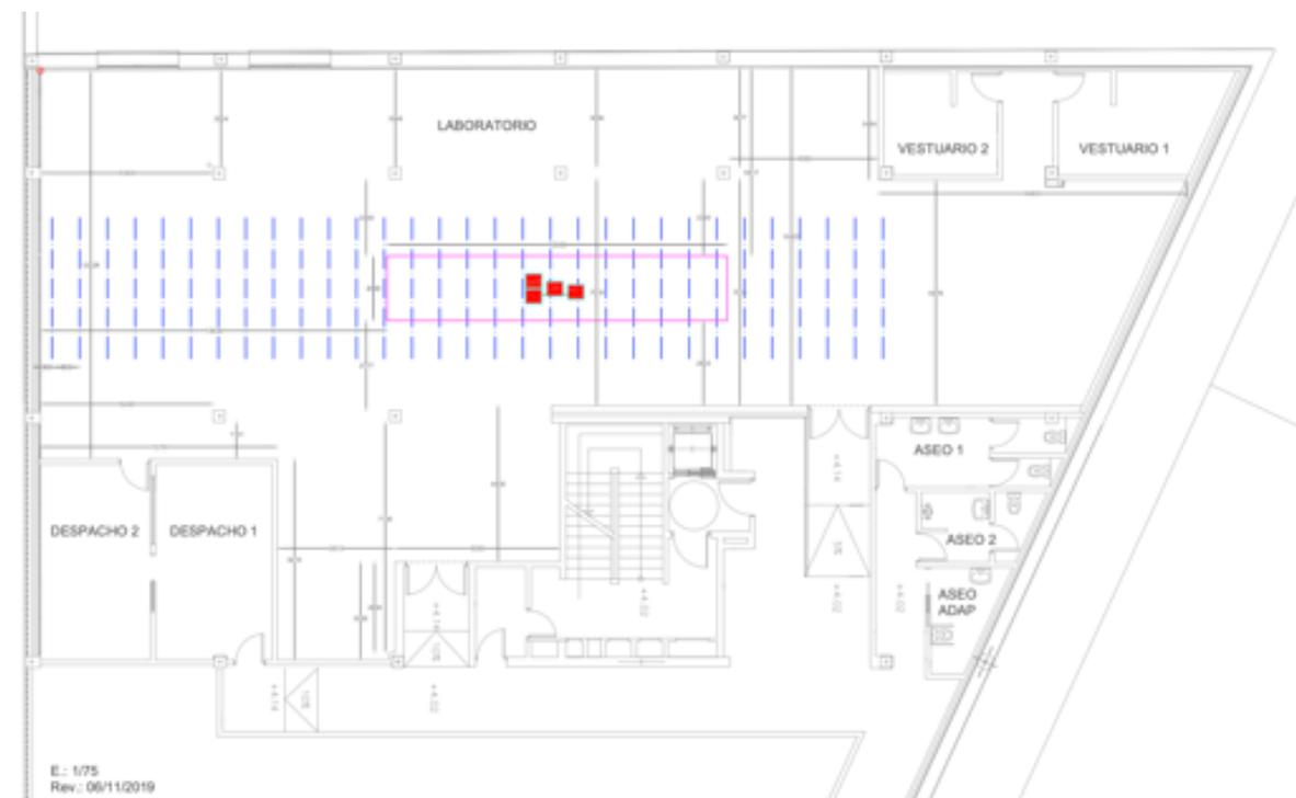
**Figura 3.** Posición de las plataformas triaxiales y suelo técnico en el espacio de laboratorio.
