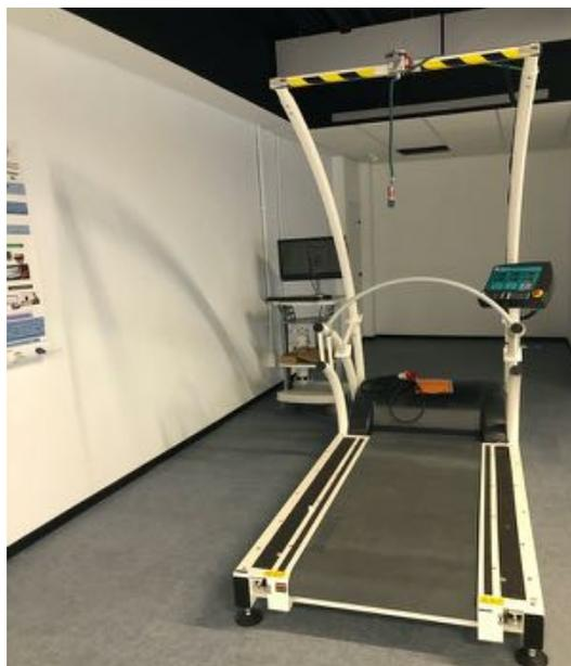
Ergómetro de uso clínico con arnés de seguridad y en el fondo, sistema de control del analizador de gases portable
