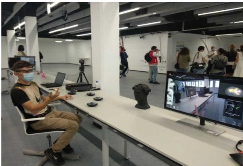
Gafas para la evaluación del seguimiento pupilar o Eye-Tracking y sistema de EEG (colocado sobre la cabeza del sujeto) en la pantalla se observa el puntero de seguimiento pupilar y la zona cerebral activada
