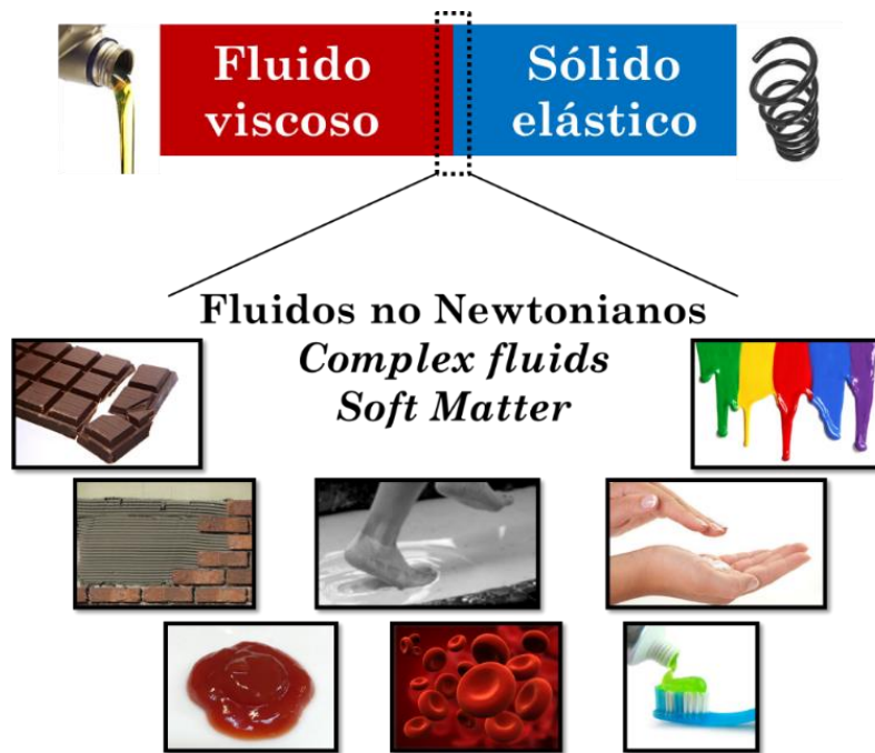
Figura 1.- Mapa conceptual. Los fluidos no Newtonianos se encuentran en la frontera entre el sólido elástico lineal de Hooke y del fluido viscoso lineal de Newton.
