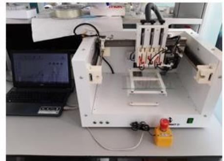
Bioimpresora estereolitográfica BiofabriLux
