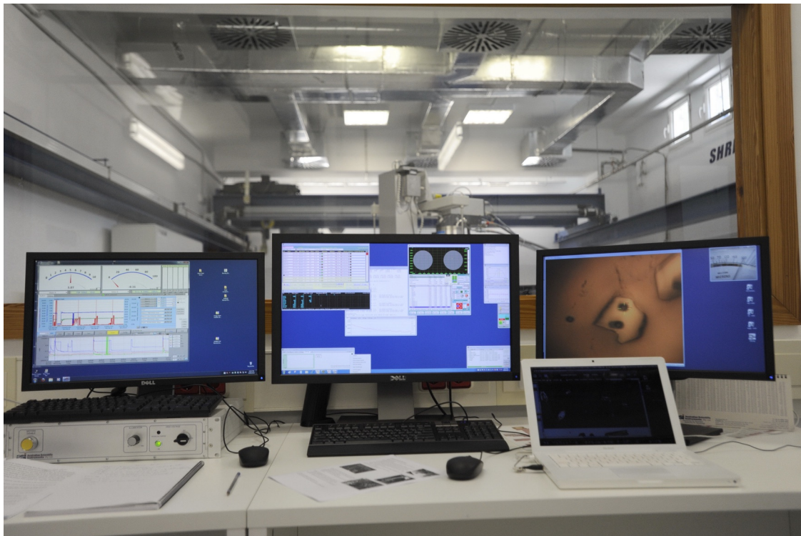
Fig.4: Sala de control mostrando las pantallas de los tres ordenadores que controlan el sistema. Esta sala está aislada del resto para evitar los ruidos y bajas temperaturas que requiere la microsonda
