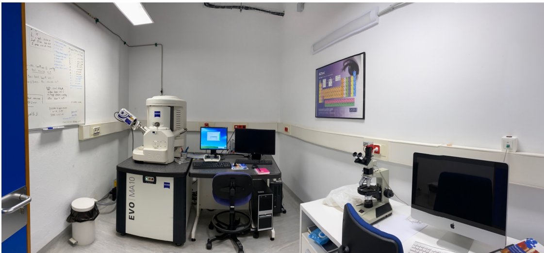
Fig.6: Sala de documentación de muestras. Consta de un fotomicroscopio óptico y un microscopio electrónico SEM equipado con detectores de electrones secundarios, retrodispersados, catodoluminiscencia y EDAX
