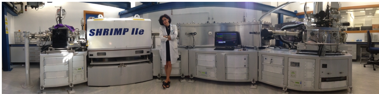
Fig. 1: Vista panorámica de la microsonda iónica SHRIMP, nótese la escala. El tubo de vuelo mide cerca de 7 m. El magneto peso 3 ton. y la máquina pesa en total unas 13 ton.
