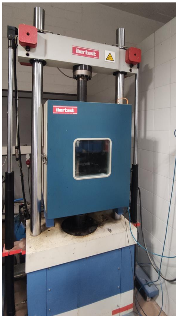
Figura 13. Detalle de la prensa dinámica multi-ensayos 50 kN.
