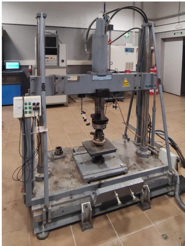
Figura 12. Detalle de la prensa dinámica multi-ensayos 130 kN.
