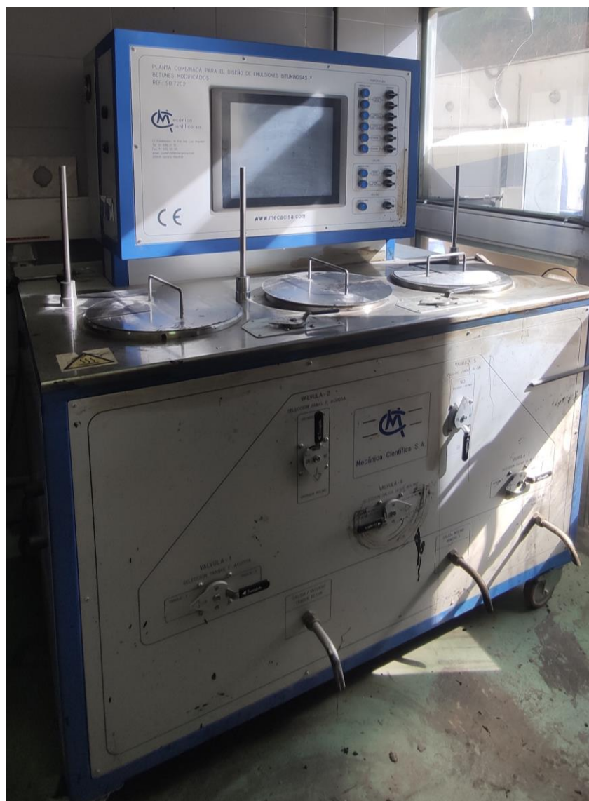
Figura 18. Planta de fabricación de betunes modificados y emulsiones.
