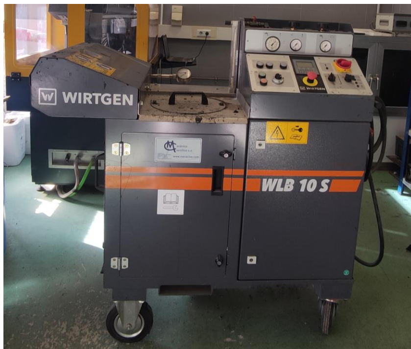
Figura 24. Central de espumación de betún.
