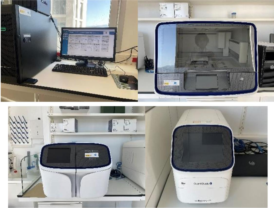
Figura 2. Servidor con sistema LIMS, HID Ion Chef™, HID Ion S5, y QuantStudio™ 5.
