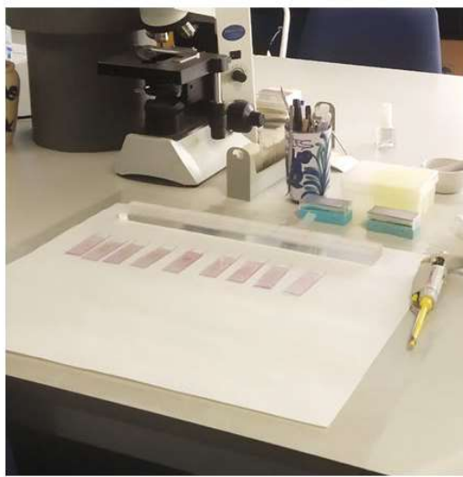
Cinta Melinex en fragmentos de 24 horas (0-24 horas UTC), colocada en portaobjetos con glicerogelatina teñida con fucsina básica
