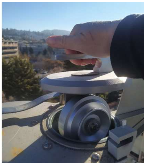
Cabezal extraíble donde se localiza el tambor que contiene la cinta Melinex
