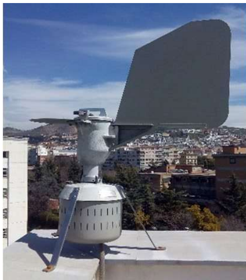
Captador Hirst para el análisis de granos de polen y esporas de hongos
